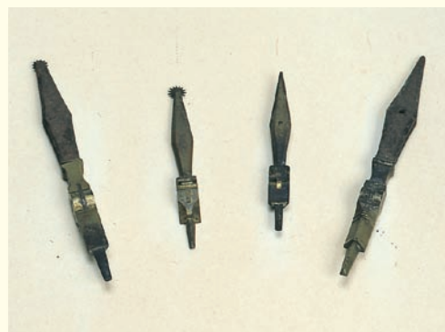
製図用具 右2本が鳥口、左2本は点線器
