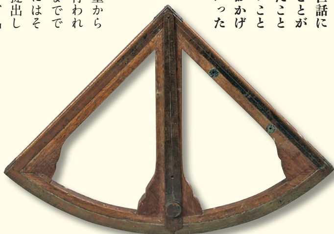
象限儀(小) 坂道の傾斜角を測ります
