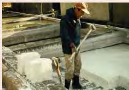
▲1985年(昭和60年)頃のでんぷん工場。沈殿槽からでんぷんの固まりを取り出しているところ。
